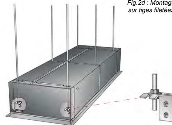
Fig. 2d : Montage sur tiges filetées
