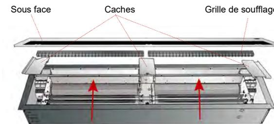
Fig. 2b : Ouverture de l'appareil pour mise en place des consoles et des tiges filetées.
