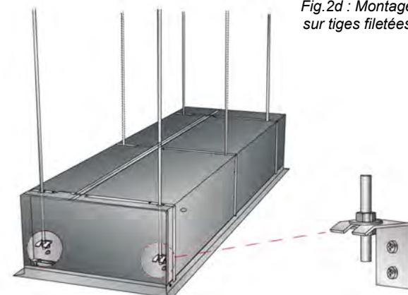
Fig. 2d : Montage sur tiges filetées
