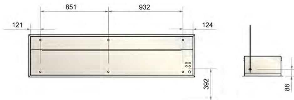
1. Au cours du transport, les consoles de montage (x 4, x 6 sur les modèles de 2 m) sont fixées à l'appareil. Les desserrer, les retourner et les visser à l'intérieur de l'appareil dans les trous prévus. Afin de pouvoir monter les consoles, enlever la sous face, la grille de soufflage et les caches (2c).
