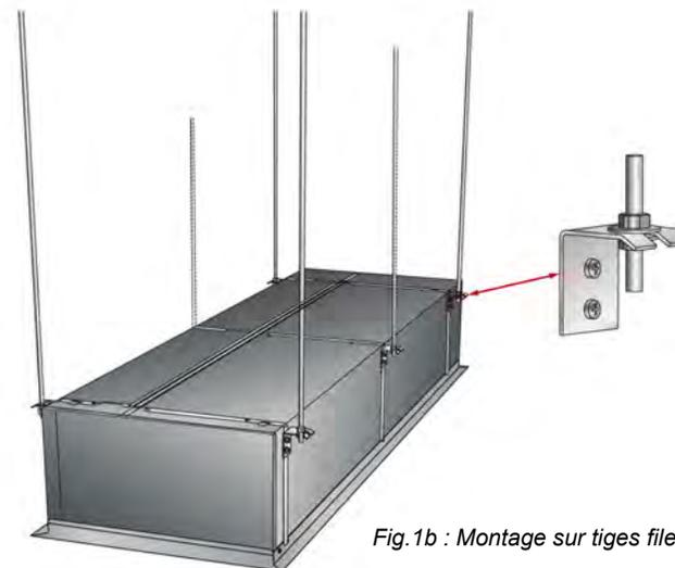
Fig.1b : Montage sur tiges filetées
